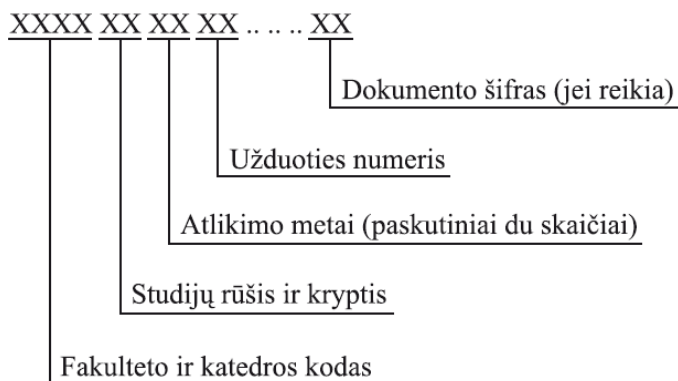
1.9 pav. Brėžinio žymens pagrindinio užrašo lentelėje struktūra
